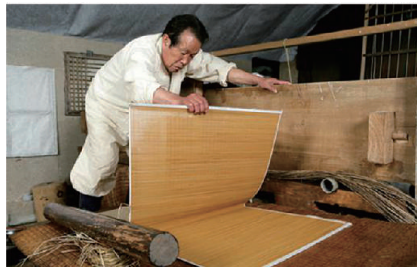
V. Formazione del foglio di carta ( V. Forming the wet sheet )
